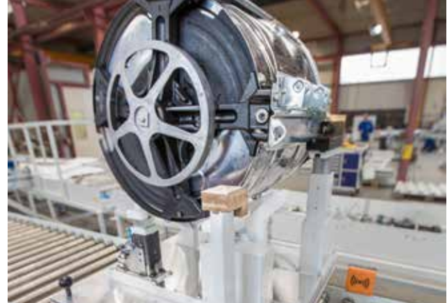
Der Werkstückträger passt sich aktiv den individuellen Produkteigenschaften an.
